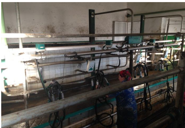
Рис. 4. Доїльна установка «Ялинка» на 4 місця
